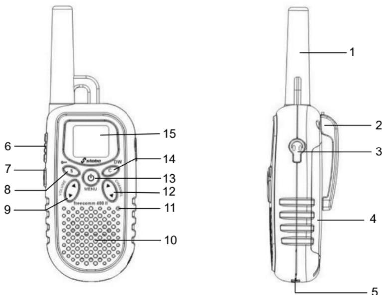
**1 Antenne** (Die Antenne ist fest mit dem Gehäuse verbunden: versuchen Sie niemals, sie abzuschrauben!)
