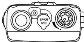
2. Dann schalten Sie das Gerät durch Drehen des Drehknopfs Lautstärke / EIN/AUS im Uhrzeigersinn, bis Sie ein Zischen hören.
