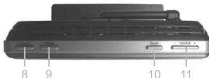
**10 Quad-Taste:** Ein-/Ausschalten der Quad-Funktion (gleichzeitige Darstellung aller vier Kamera-kanäle auf dem Monitor).
