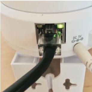
Die grüne LED blinkt, nach ca. 15 Sekunden leuchtet die gelbe LED. Die Verbindung zwischen Kamera und Router ist jetzt hergestellt.
