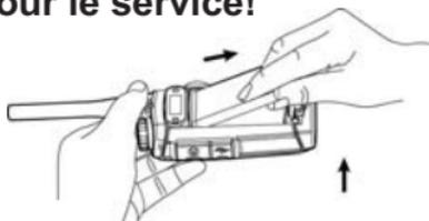
2. Insérez l'accu dans l'appareil en prenant les marquages + et - ainsi que la cheville d'arrêt en considération et poussez-le dans le compartiment de batterie.
