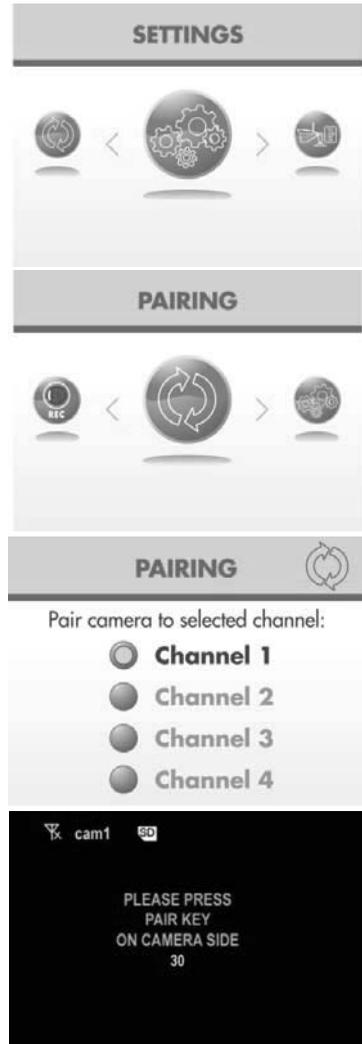
Drücken Sie nun innerhalb der nächsten 30 Sekunden die PAIR-Taste an der Frontseite der Kamera.
