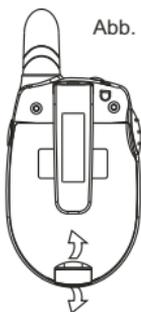
Zum Öffnen des Batteriedeckels entriegeln Sie den Schnappriegel an der kreisförmigen Einkerbung (siehe Abb. 3) und nehmen den Batteriedeckel ab.
