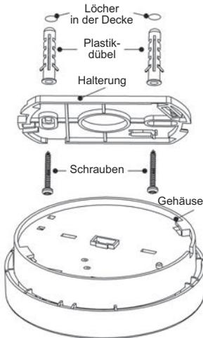
Markieren Sie an der Montagestelle die beiden Bohrlöcher, nutzen Sie dabei den Halter als Schablone.
